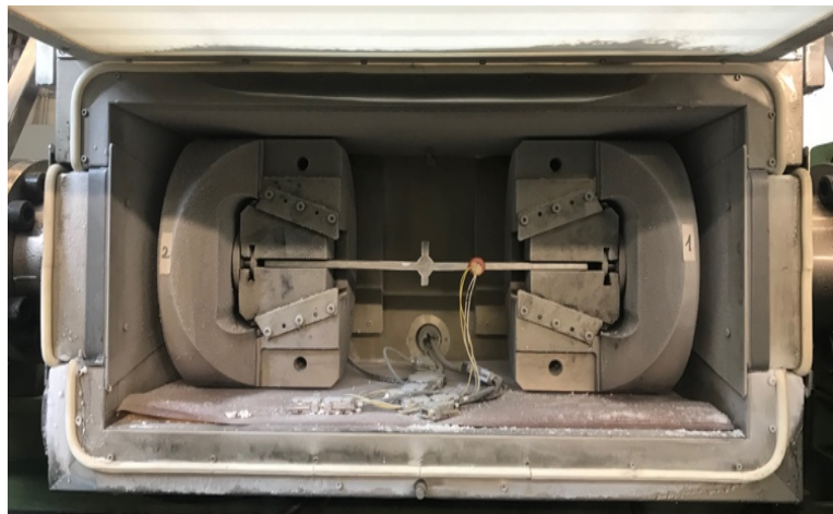
Abb.: Darstellung einer Offshore Windenergieanlage mit Jacket Struktur (links) von Dong et al. (2012) und Tieftemperaturversuchsstand
